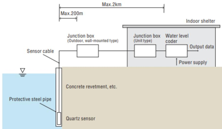
**Figure 2.12. Configuration diagram**
